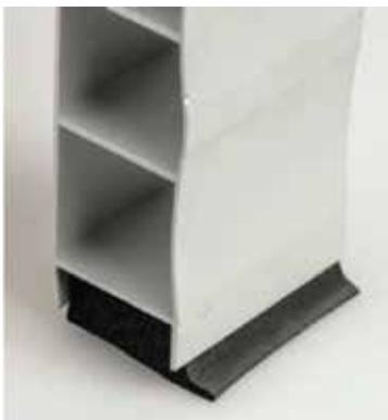
Les joints sont installés en usine. Ils permettent une étanchéité parfaite entre la barrière, les murs et le seuil. Ils sont fabriqués en mousse EPDM à cellules fermées. Clipsés dans le profilé, les joints peuvent être aisément remplacés.
