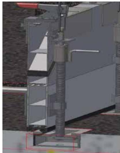
Vue en coupe au niveau de la tige de compression et du boîtier de sol.
