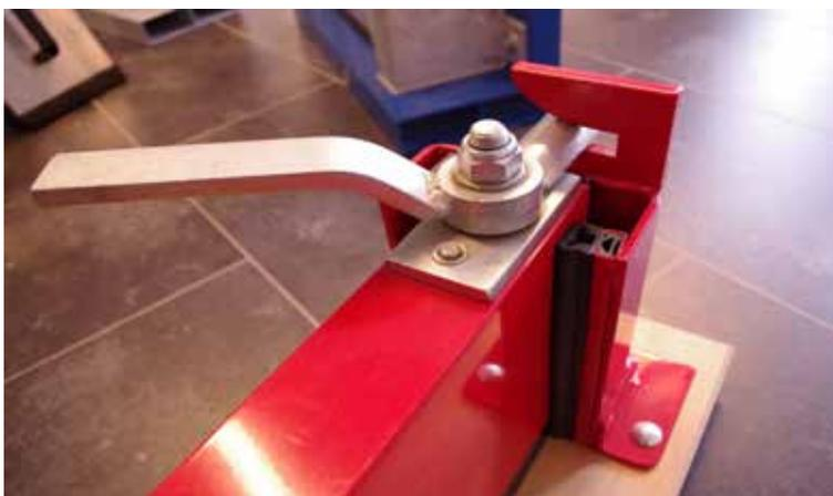
Traverse mise en place entre les rails verticaux. Verrouillage grâce à la rotation des poignées de compression dans leur logement pour assurer l'étanchéité de la barrière.
