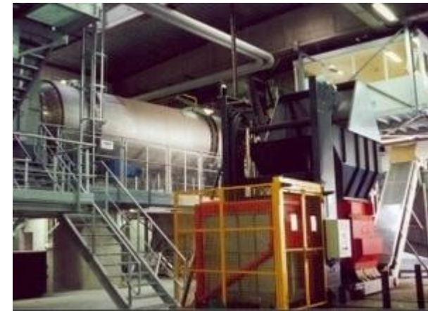
Gamme FRI Chambre de combustion Rotative de 500 kg/h à 5 000 kg/h
