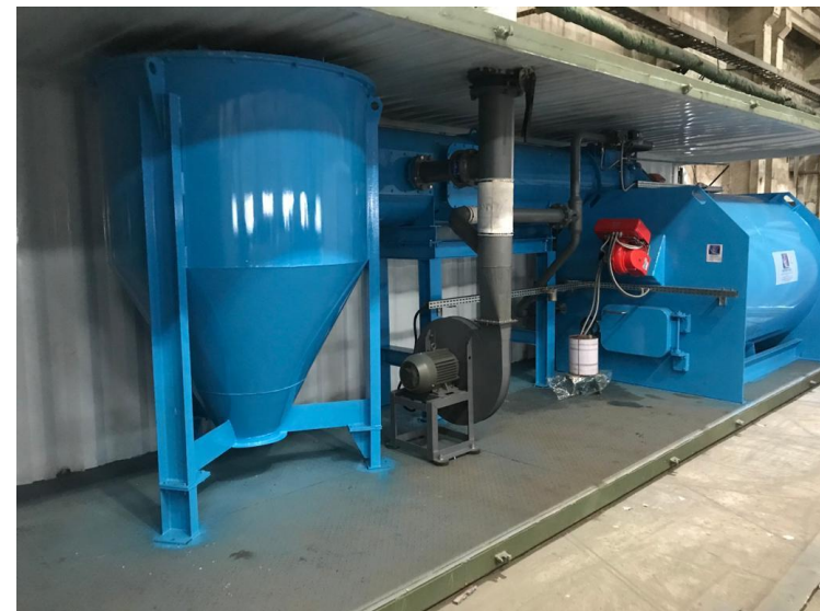
Ligne d'incinération en conteneur
