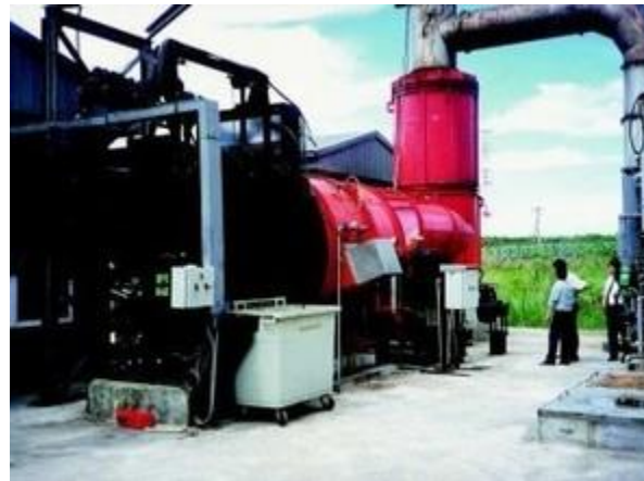
Gamme HDI Chambre de combustion Statique de 100 kg/h à 3 000 kg/h
