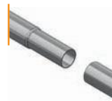
Raccordement des lisses par rétreint
