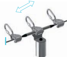
Passage à distance des intermédiaires avec chariot et pièce intermédiaire adaptée
