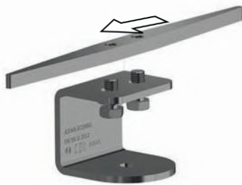
Fixation par boulonnage du support de rail.
