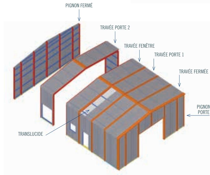
Nous avons développé 7 modèles aux dimensions standard qui pourront s'adapter à tous les besoins. Ces modules peuvent incorporer sur le côté, des portes et des fenêtres; il existe 4 types de modules pour chacun des 7 modèles: module fermé. Porte piétonnière à un battant, porte piétonnière à 2 battants et fenêtre.
