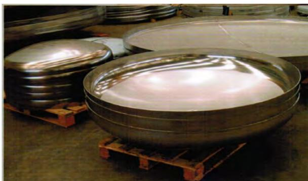
**FONDS BOMBES** - Pour la construction de cuves, réservoirs et citernes.
