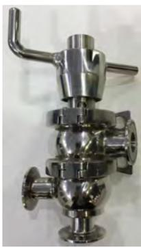
**VANNES A CLAPET:** - Vanne facilement démontable pour les phases de nettoyage
