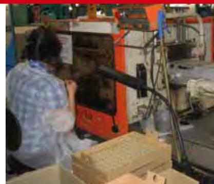
Fabrication des composants plastiques des lampes Boxer et Gripper
