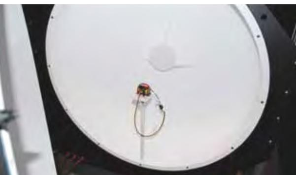
Tests en sphère intégrante réalisés sur la lampe Boxer 450
