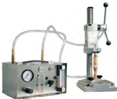
**Outillage de test pour la vérification annuelle des pare-flammes et des clapets anti-retour jusqu'à DN 50, pour tester :**
