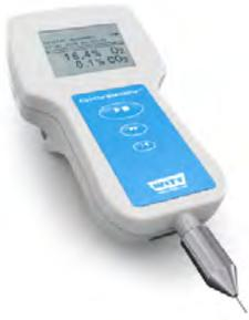
**Analyseur portatif compact p. ex. pour le contrôle des emballages MAP (modèle de base)**
