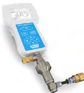
**Analyseur O<sub>2</sub>/ CO<sub>2</sub> portatif pour les réseaux sous pression, par ex. pour le soudage (modèle premium)**
