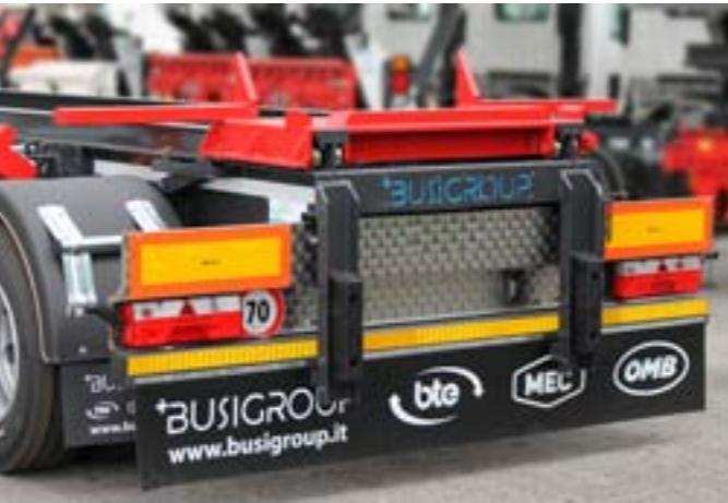
Rimorchi scarrabili 2 o 3 assi allestiti con attrezzatura scarrabile standard con blocaggi esterni, carrello con 8 cuscinetti, telaio guida a "T"
