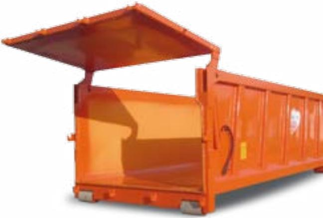
Portellone basculante idraulico azionato tramite impianto del veicolo a collegamento con innesti rapidi e/o pompa a mano.
