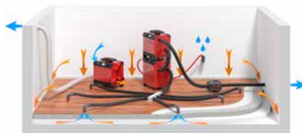
Une turbine assèche par aspiration une construction de plancher avec un séparateur d'eau et un filtre combiné.
