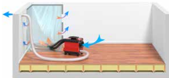
Optimisez le résultat d'assèchement avec la pose d'un polyane.
