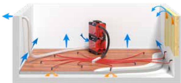
Assèchement par insufflation, à l'aide d'un déshydrateur et d'une turbine, d'une chape avec isolant et d'une cloison en chevrons simultanément.
