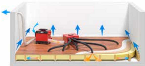
Déshydrateur et ventilateur basse pression asséchant un plancher à solivage.
