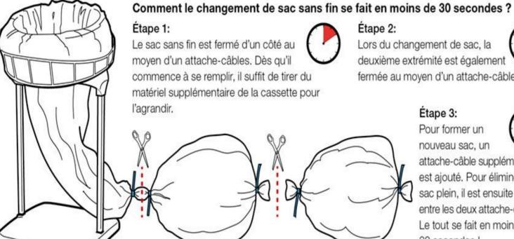
Lors du changement de sac, la deuxième extrémité est également fermée au moyen d'un attache-câbles.
