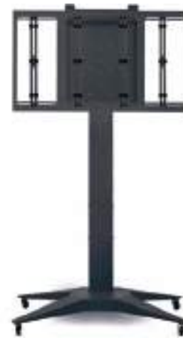
12160 TOTEM-XL Support TV jusqu'à 65" Compatible Vesa jusqu'à 1000x400 - Dim. : 820 x 1080 x 1900 mm - Réglage fixation Horizontale TV : 74-406 mm et 594-1000 mm - Réglage fix. Vertl. TV : 82 à 475 mm - 2 positions pour le TV : 1250 ou 1650 cm du sol (centre TV) - Livré avec 4 roulettes - Charge max : 70 kg / Pds : 55.5 kg EU-12160 Noir .1 091,51 € HT 06 EU-08851 Gris ...962,54 € HT 06
