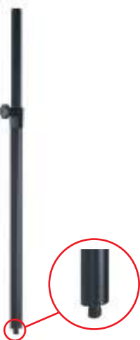
01282 TUBE D'ENCEINTE Tube Alu télescopique noir - 35 mm / M20 - Longueur 905 à 1615 mm - Haut : diam 35 mm mâle - Bas : Filetage M20 mâle - Charge max : 30 kg / Poids : 1 kg
