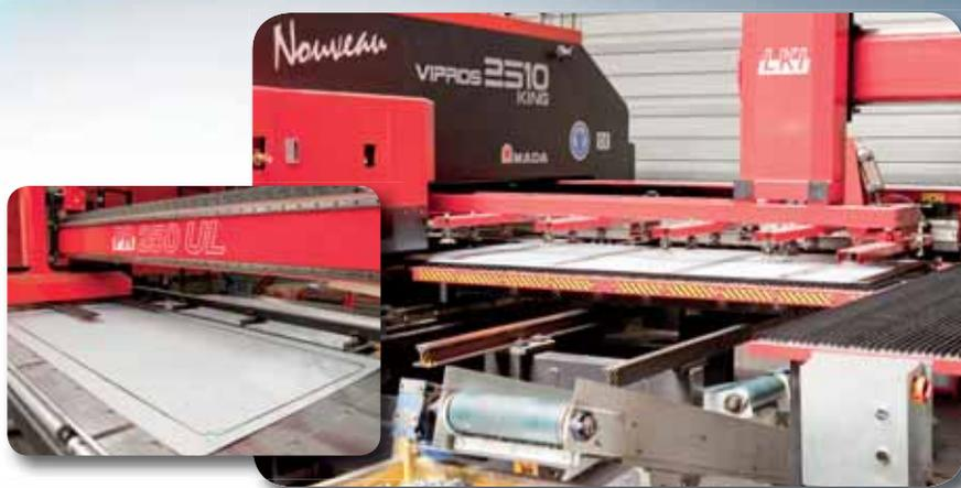
Poinçonneuse numérique automatique
