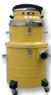
Le CH450 est un aspirateur compact qui ne fait que 105 cm de haut pour un poids de 48 kg mais qui a les capacités de plus gros aspirateurs existants sur le marché actuel. Son bi-moteur de 2700 W lui permet une dépression de 2600 mm H<sub>2</sub>O. Il est également équipé d'un filtre absolu HEPA recouvert de Téflon et d'un système de décolmatage automatique breveté.
