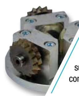
Boucharde à main étoilée double rangée 100 % carbure. Ces plateaux sont équipés de joints spécial bouchardes et de doubles roulements pour une meilleure résistance aux chocs. Les supports, très légers, sont en aluminium et l'ensemble est monté sur *silent blocks* : un vrai confort de travail !
