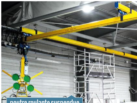
poutre roulante suspendue
