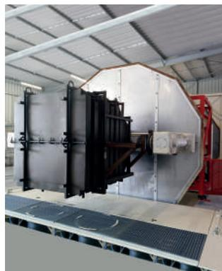
Shuttle rotatif 2 bras en C - Rotomoulage de pièces en polyéthylène - Plasturgie
