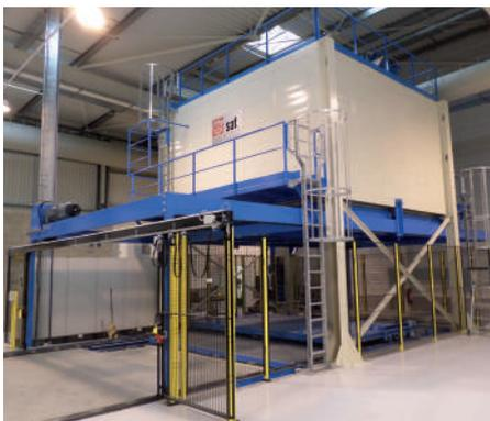
Four de traitement thermique - Trempe de pièces d'aluminium - Aéronautique
