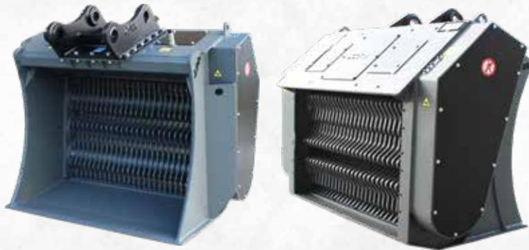
Godet cribleur broyeur à rotors projeté par une haute productivité sur les terrains humides. Par son utilisation facile et intuitive, il est idéal pour trier / cribler / broyer / recycler les différents matériaux (humides/secs, légers/lourds, abrasifs).
