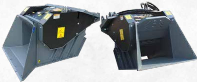
Godet concasseur conçu pour le concassage de matériaux inertes directement sur site. Convient aux mini-pelles de 4 à 12 tonnes et aux chargeuses compactes et chargeuses-pelleteuses de 3 à 12 tonnes.
