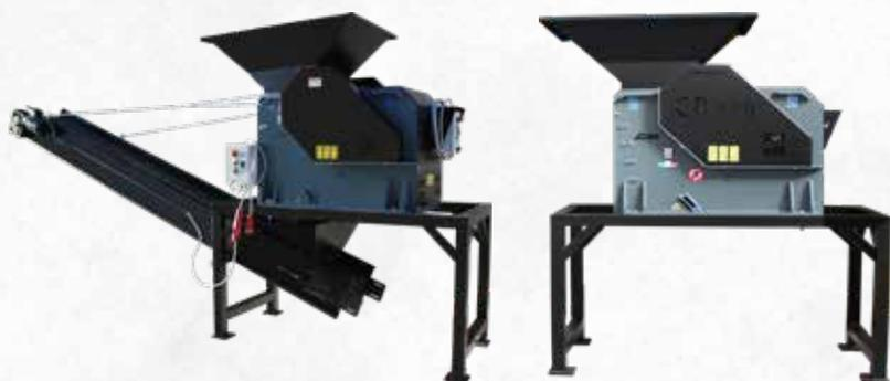
Mini concasseur à mâchoires électrique idéal pour le recyclage de matériaux inertes issus de petites démolitions, excavations ou pour le concassage de pierres naturelles, roche, marbre, tuiles.
