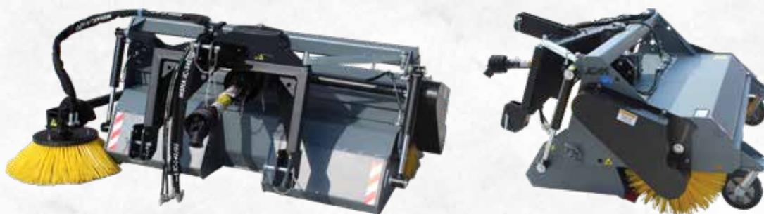
Balayeuse polyvalente conçue pour être spécifiquement appliquée aux tracteurs. Entraînement par cardan, avec godet de ramassage, brosses en polypropylène, 2 roues de support pivotantes, ouverture hydraulique du godet. Produit avec des largeurs de 130 à 280 cm d'utile. Possibilité de relever le godet pour le transformer en balayeuse orientable pour balayer la neige ou simplement pour balayer le bord de la route.
