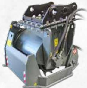
La Raboteuse pour pelles Série FSE a la fonction de démanteler les croûtes du revêtement routier, le ciment des aires de stationnement, de gratter la roche ou de créer simplement des passages ou traces où il y a l'asphalte.
