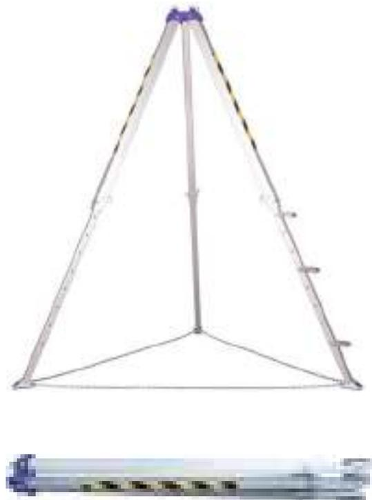
Le modèle AG\_TMC13 dispose de trois supports de marche pied en aluminium facilitant l'accès à l'accrochage en position déployée. Il est équipé de deux poulies, avec système anti-dégagement garantissant le guidage du câble des treuils. Doté de trois points d'ancrage, il permet un levage de charges jusqu'à 1t. Les pieds sont réglables sur neuf positions et disposent d'un ruban réfléchissant. Ils sont munis de patins orientables avec une surface antidérapante en caoutchouc.
