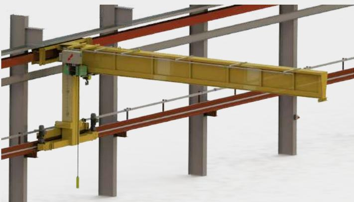
Accrochée aux murs latéraux elle fonctionne en se déplaçant de latéralement et horizontalement.
