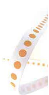
La technologie de bande Chemcassette® est une méthode de détection de gaz toxiques sans étalonnage. Elle utilise un système d'analyse optique pour détecter la présence d'un gaz, confirmée ensuite par le changement de couleur d'une bande de papier spéciale imprégnée chimiquement. La technologie Chemcassette® est très précise et réagit extrêmement rapidement à de nombreuses concentrations de gaz dangereux en parties par milliard (ppb).
