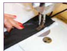
Ganse élasthanne pour épouser parfaitement la forme du mât
