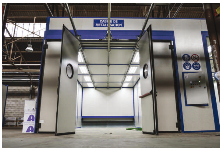
CABINE DE METALLISATION
