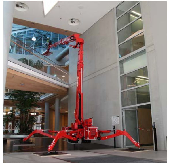
Les bras inférieurs et supérieurs s'opèrent indépendamment pour passer les obstacles
