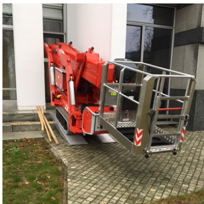
Encombrement minimal avec une largeur de 0,98 m
