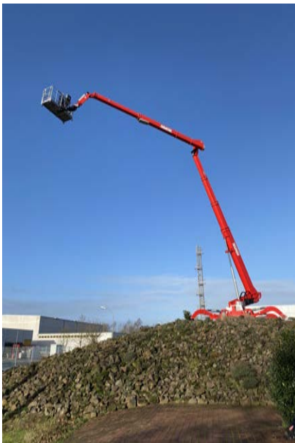
Bras inférieur et bras supérieur peuvent être opérés indépendamment
