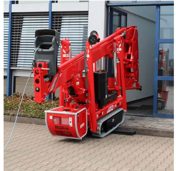
Encombrement minimal avec une largeur de 0,78 m grâce au panier détachable
