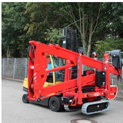
Chargement/ déchargement possible par chariot
