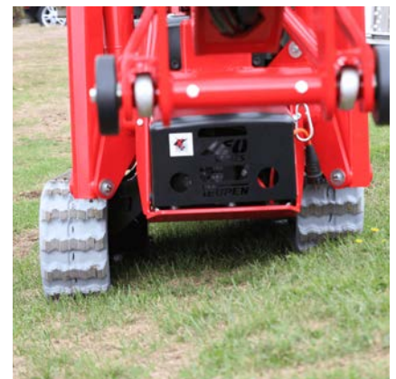
En option, ajustement mécanique du train de chenille en hauteur et en largeur
