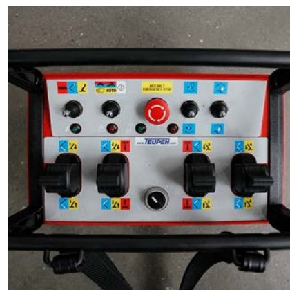
Commande à câble en série- Radio-commande en option
