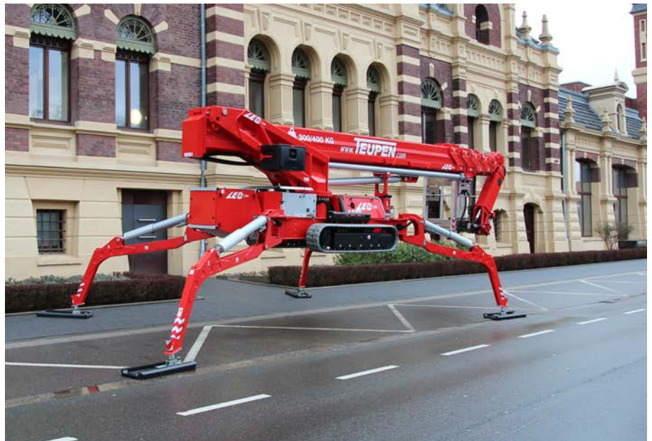
Trois positions de stabilisation différentes: large des deux côtés, étroit des deux côtés, demi-calage
