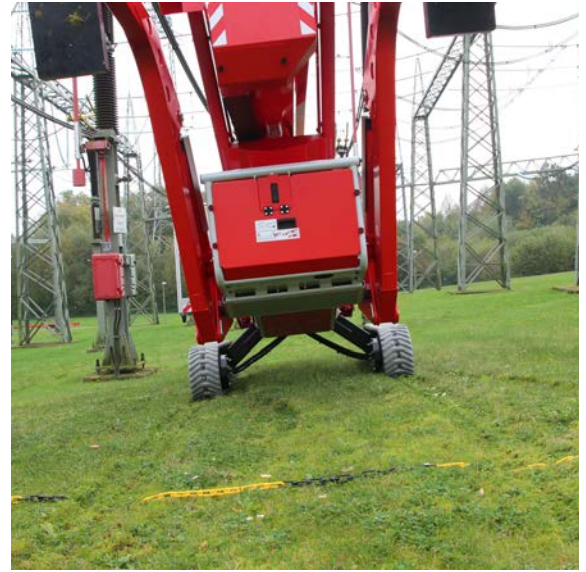
Train de chenille ajustable en hauteur et en largeur pour compenser les différences de niveaux
