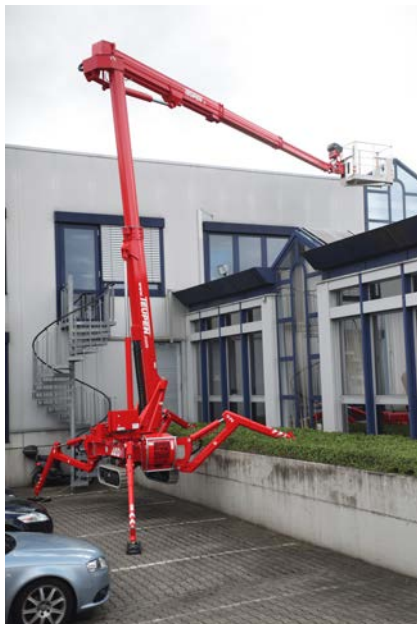
Stabilisation en dévers jusqu'à 19,0 ° / 34,0 %
