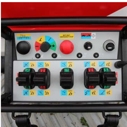
Prise en main facile grâce à la radio-commande et ses fonctions codifiées par couleur
