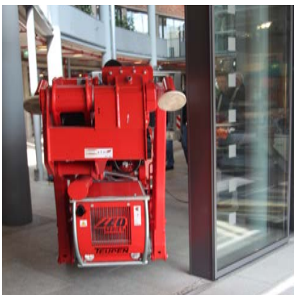
Encombrement minimal avec une largeur de 0,98 m
