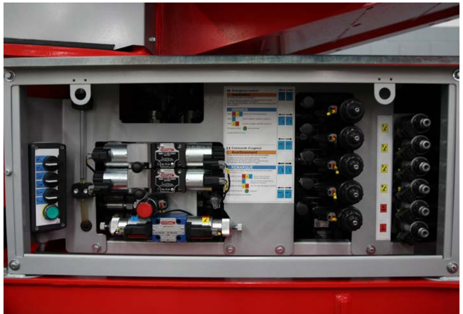
Le système de descente de secours électrique est facilement accessible et suit un mode opératoire simple en 3 étapes
