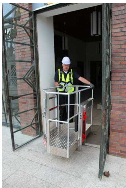
Encombrement minimal avec une largeur de 0,78 m grâce au panier détachable
