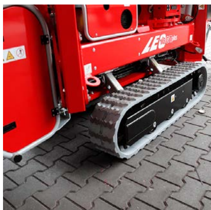
Train de chenilles ajustable en hauteur et en largeur pour compenser les différences de niveaux
