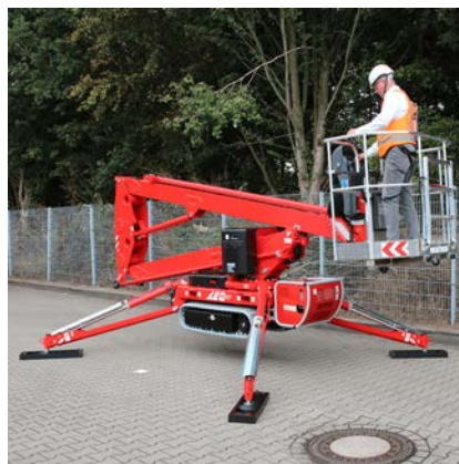
Stabilisation et nivellement automatique
