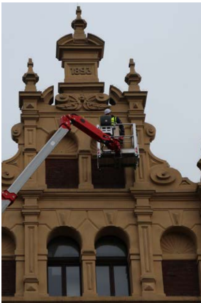
Rotation du pendulaire (180 °) et du panier (2x 90°)
