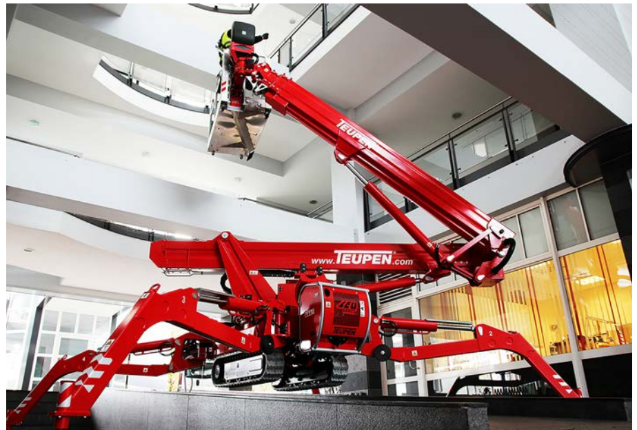
Tourelle rotative (450 °) Panier rotatif (2x 90 °)
