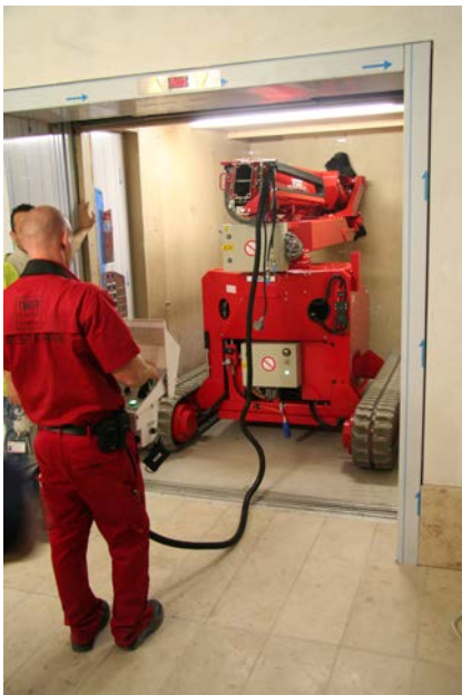
Conception compacte pour passer dans un monte-charge
