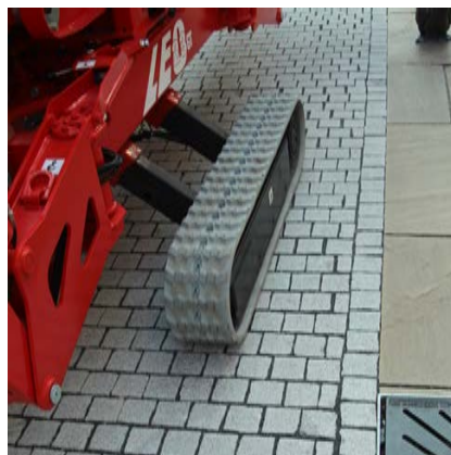
Train de chenille ajustable en hauteur et en largeur
