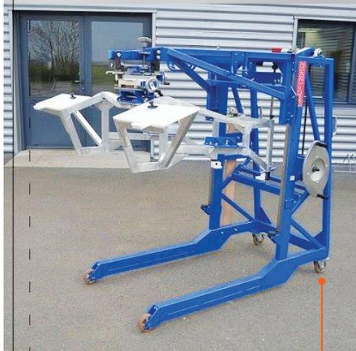
Châssis à positionnement
