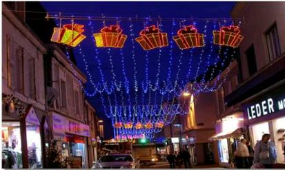
Les ciels de rue se raccordent latéralement. Ils sont prémontés sur un support aluminium. La pose est ainsi facilitée. Chaque ciel doit être soutenu par un câble au minimum tous les 10m
