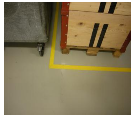
Délimitation de zone de stockage
