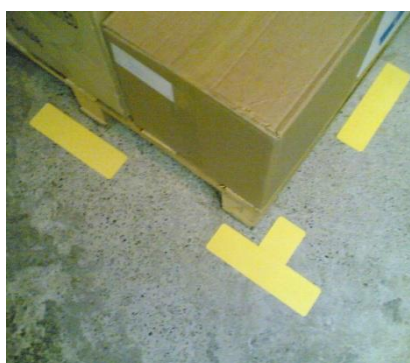
Marquage au sol « T » et « - » vierges
