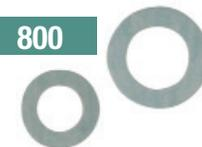
\* **Sur demande** : Joints Fibres pour raccords réf. **2425FT** et **2425F** du DN12 au DN40 ép. 2 mm (T° -10 °C à +160 °C)
