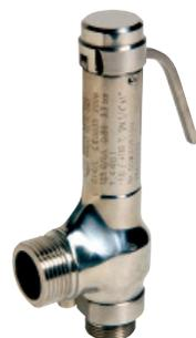
**2863** SOUPAPE INOX À ÉCHAPPEMENT CANALISÉ ET LEVIER POUR VAPEUR PORTÉE PTFE
