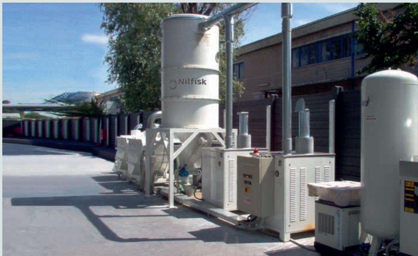
Les convoyeurs pneumatiques électrique et air comprimé sont les outils les plus performants pour déplacer la poussière et les granules. Ils peuvent transporter la poussière et les granules à partir d'une cuve vers des machines-outils ; on les utilise, par exemple, pour alimenter des mélangeurs, des réacteurs, des tamis vibrants, des granulateurs, des machines à capsuler, des compresseurs ou des machines d'emballage.
