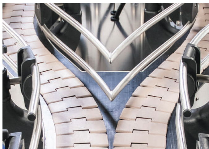
Réalisation de convoyeurs sur mesure en aluminium anodisé ou inox avec courbes de transferts
