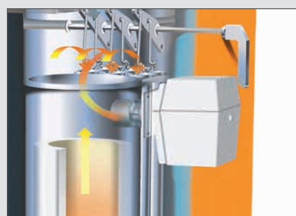
Combinaison brûleur à mazout
