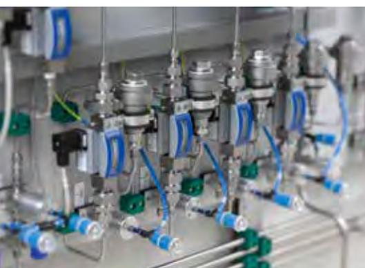
Réglage de l'inertage avec des débitmètres de purge
